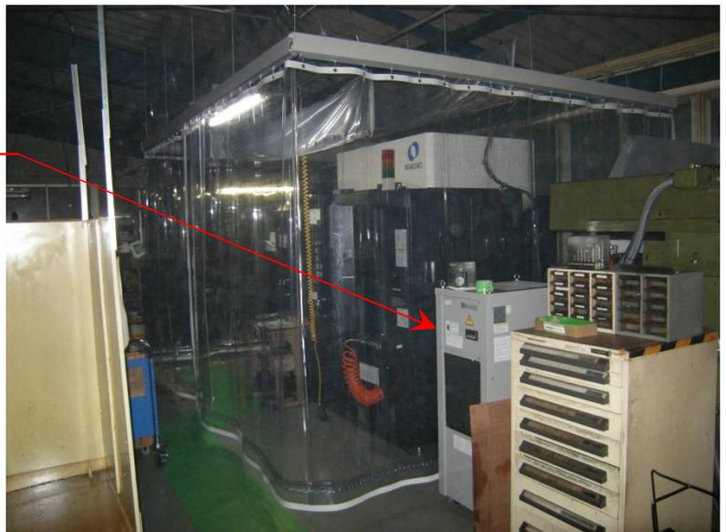
機能維持とコスト削減を両立させるため、吹出しはビニールダクトを用い、機械上部からの縦吹きを確保しました。
